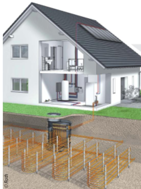
Dans le système hybride Solargeo de Roth, associant une PAC géothermique et des panneaux solaires, le solaire peut représenter 25 % de l'énergie pour le chauffage et l'eau chaude.
