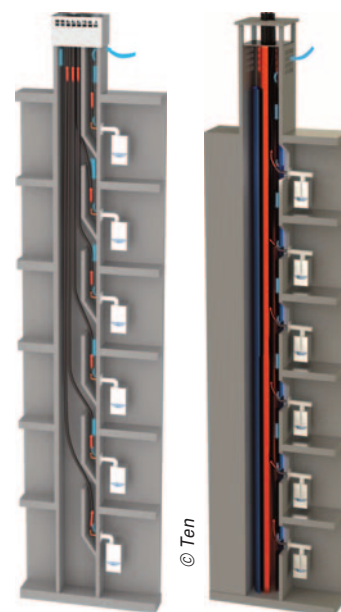
Ses systèmes Techna-Shunt et Techna-3CE sont proposés complets, avec sortie de cheminée et conduit flexible PVDF, connexions murales conduits flexibles/rigides PVDF, conduit de liaison, raccordement concentrique PVDF/alu, température 160 ° C.
