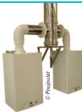
Le Rolux 3CEp Rénovation d'Ubbink : jusqu'à sept chaudières raccordées (un appareil raccordé à chaque niveau), trois diamètres (110, 125 et 160 mm) et une livraison en kits complets, entreposés dans l'ordre d'installation.
